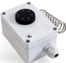
Kapillarrohrthermostat zur Raumtemperaturregelung, Temperaturbereich: 5 bis 60 °C, Spannung: 230/400 V, Schaltstrom: 16/6A, Schutzart: IP 55,
