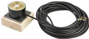
Eis- und Schneefernfühler für Freiflächenheizungen. Beheizter Fühler, der im unbeheizten Teil der Fläche montiert wird. Dient zur Erfassung des einsetzenden Schneefalls. Länge: 15 m.
