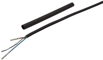
Kaltleiter für Heizmatten BRS, GSN und DSN mit 400 V, 2-polig mit Schutzgeflecht 2,5 mm<sup>2</sup>. Wir produzieren die Anschlussleitung je nach Bedarf bis zum Anschlusspunkt. Standardmäßig sind 3 m Kaltleiter enthalten, Überlängen werden gesondert berechnet, d.h. Gesamtlänge minus 3 Meter.
