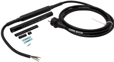
Werkseitige Konfektionierung von maßangefertigten Dachrinnenheizbändern mit Doppelthermostat in Anschlussmuffe, inkl. 3 m Steckerleitung und Endabschluss. Das Thermostat ist zu 100 % feuchtigkeitsgeschützt und ist im Bereich zwischen -5 °C und +3°C eingeschaltet. Unter -5 °C und über +3°C wird es wieder ausgeschaltet. Die Steckeranschlussleitung ist 3 m lang und UV-beständig.
