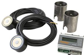
Vollautomatische Regelung für Freiflächenheizungen (Treppen-, Rampen-, und Straßenbeheizungen), Eismelder-Set inklusive Fühler und Hülse für den Einbau in Beton und Kopfsteinpflaster. Montage: auf Normtragschiene, LCD-Anzeige der Istwerte Temperatur, Feuchte-Betrieb, Fehlerstatus, Betriebsstundenzähler, Nachheizfunktion einstellbar, Alarmausgang für Fühlerfehlfunktion, Relaisausgang 16 A. Inklusive Temperaturfühler ET-33004, Eis- und Schneesensor ET-33001, Systemaufbau: CE konform nach EN 60730.
