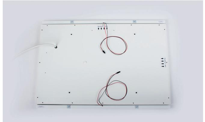
3. Legen Sie die Streben auf der Rückseite über die vorgebohrten Löcher der Infrarotheizung und stecken Sie die Schraubgewinde auf den Profilen durch die dafür vorgesehenen Löcher auf der Schiene. Befestigen Sie die Streben mit den beiliegenden Schrauben an der Infrarotheizung.
