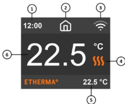
Le fait d'appuyer sur le bouton au centre de l'écran principal permet d'accéder au menu principal. Le fait d'appuyer sur le bouton de gauche ou de droite permet de modifier la température définie.
