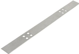
Kantenschutz für Ablaufrohrenmündung und als Distanzhalter bei Doppelverlegung in Kastenrinnen bis 200 mm und zur Dachbefestigung, Abmessung: 25x300x1 mm, aus Niro Blech für 2 Heizbänder, exkl. Kabelbindern
