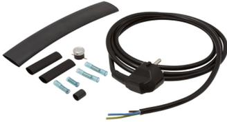
Werkseitige Konfektionierung von maßangefertigten Rohrbegleitheizbändern mit Thermostat in Anschlussmuffe, inkl. 2 m Steckerleitung und Endabschluss. Das Thermostat ist zu 100 % feuchtigkeitsgeschützt und schaltet den Frostschutz bei Gefahr unter +3 °C ein und bei +10 °C wieder aus.
