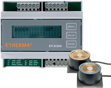
Der Eismelder ET-8352F ist eine vollautomatische Steuerung für Freiflächenheizungen (Treppen-, Rampen-, und Straßenbeheizungen). Montage: auf Normtragschiene, LCD-Anzeige der Istwerte Temperatur, Feuchte-Betrieb, Fehlerstatus, Betriebsstundenzähler, Nachheizfunktion einstellbar, Alarmausgang für Fühlerfehlfunktion, Relaisausgang 16 A. inklusive Temperatur- und Feuchtefühler ET-33002 und Eis- und Schneensensor ET-33001, Systemaufbau: CE konform nach EN 60730.
