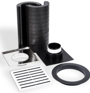
Außenwanddurchführung mit Wetterschutzgitter, Insektenschutzgitter und Dämmhülsen für das Luftverteilsystem der Brauchwasserwärmepumpe WHP, für Wandstärken von 300 bis 600mm, Wärmebrückenfrei durch EPP-Rohrhülse Durchmesser 200mm Innen und Durchmesser 300mm Außen
