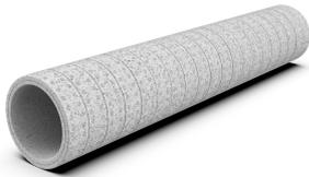
Die isolierte Mauerdurchführung für die FIRE+ICE Wärmepumpe ist für eine 200 mm Kernbohrung ausgelegt. Dichtheitsklasse ATC1 nach DIN-EN 17192. Die glatte Innenwand garantiert einen geringen Strömungswiderstand. Der Außendurchmesser beträgt 195 mm, der Innendurchmesser 160 mm. Das Rohr kann einfach mittels Cutter zugeschnitten werden. Material: EPS; Wärmeleitfähigkeit: 0,029 W/mK, Länge: 1 m, VPE: 1 Stk.
