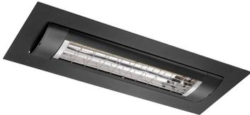
Der SOLAMAGIC D3 Deckeneinbaustrahler ermöglicht einen sicheren und dezenten Einbau des Premium-Dunkelstrahlers in unterschiedlichsten Deckenkonstruktionen, vor allem aber im geschützten Außenbereich und Innenbereich. Das Gehäuse und der Einbaurahmen sind aus hochwertigem Aluminium gefertigt. Das Gerät ist mit einer Solastar-AL No Glare Heizröhre ausgestattet, die neben hoher Effizienz und einer sehr hohen Lebensdauer (ca. 5000 Betriebsstunden) besonders durch den geringen Restlichtanteil (
