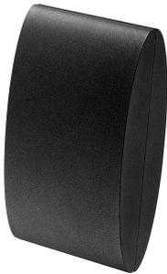
Mit dem SOLAMAGIC Funk-Dimm-Modul X2 können die Strahler S1+ und D3 stufenlos gedimmt werden. Das Modul wird in Schnellmontage an den Strahler gesteckt. Als Zubehör ist der 4-Kanal Funk-Handsender erforderlich. Das Dimm-Modul ist in folgenden Farben erhältlich: Weiß, Titan und Nano-Anthrazit, für Strahler bis 2 kW, Schutzart: IP 44, Abmessungen: 115 x 200 x 92 mm, Reichweite: ca. 20 m, 230 V.
