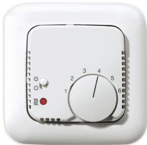
Der Fußbodentemperaturregler besitzt einen Ein- Aus Schalter und eine LED: Heizung ein. Spannung 230V, Schaltstrom 16A, Schutzart IP30, Bodenfühler 4m Farbe reinweiß, ähnlich RAL9010 Montage auf Schaltdose
