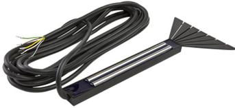
Eis- und Schneefernfühler für Dachrinnenheizung, Positionierung an der tiefsten Stelle der Dachrinne. Minimaler Abstand zum Heizband oder Heizleitung ca. 2 cm. Länge: 4 m.
