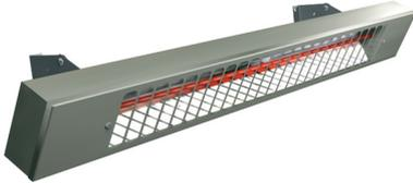
Der Quarzstrahler EIR bietet das ganze Jahr über Komfort für Werkstätten und Lagerräumen zum gezielten Heizen von begrenzten Flächen. Reflektoren aus hochglanzpoliertem Aluminium mit maximaler Korrosionsbeständigkeit. Verstellbare Montagekonsolen für eine einfache Wand- oder Deckenmontage. Farbe: Aluminium poliert, max. Elementtemperatur: 750 °C, empfohlene Montagehöhe: 2.2 bis 2.5 m, Schutzart: IP 44, Prüfzeichen: CE konform.
