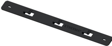
An den Ecken abgerundeter Distanzhalter aus Kunststoff zur speziellen Verwendung für Heizbänder bei Doppelverlegung auf Foliendächern und zur Befestigung auf Dächern, für bis zu 3 Heizbänder, UV-beständig, über einfaches Befestigungssystem untereinander verbindbar.
