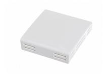
Der Temperaturfernfühler ist in einem Polycarbonatgehäuse untergergebracht und kann mittels Wandmontage als Raumfühler eingesetzt werden. Der Anschluss erfolgt rückseitig über eine interne Schraubklemme 2-polig, Abmessungen: 88x25x82mm (BxHxL), Temperaturbereich - 50 bis 105 °C.
