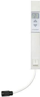
Das Thermostat LAVA-R kann im Plug & Play-Stecksystem an den LAVA 2.0 einfach montiert werden. Die Oberflächentemperatur lässt sich begrenzen. Stufe 1: ca. 60 °C, Stufe 2: ca. 95 °C. Zusätzlich kann man die Raumtemperatur von 0-35 °C einstellen.
